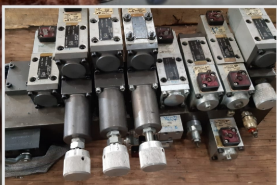
Revisão em bloco manifold de equipamento têxtil
