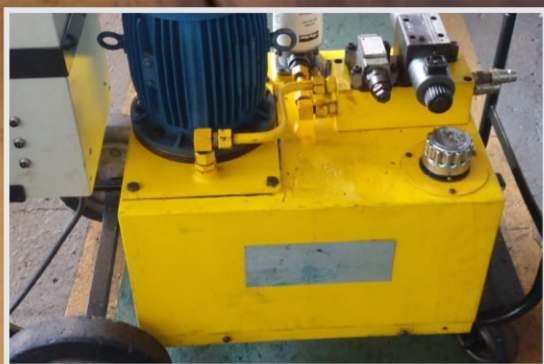
Revisão em UH acionamento de ferramenta degolar tubos
