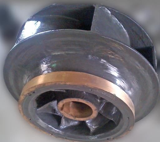
Revestimento de rotor de bomba
